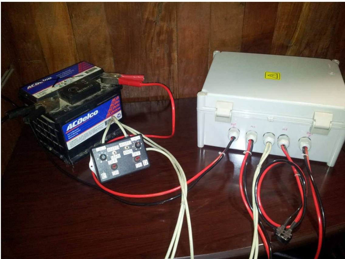
Fig 31 A alimentação, o módulo de potência e o controle remoto
