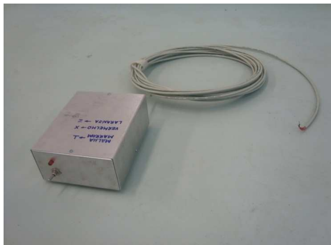
Fig 18 A caixa de instalação do giroscópio [1]
