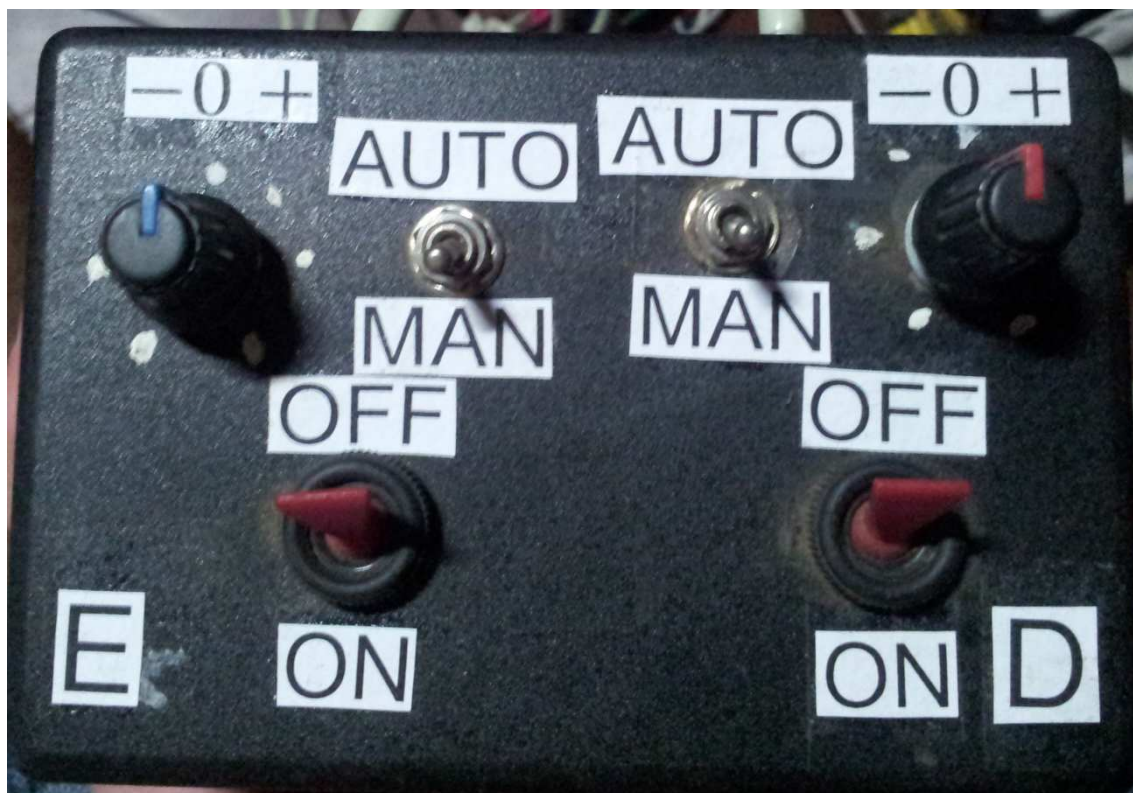
Fig 32 As funções do controle remoto para dirigir o módulo de potência
